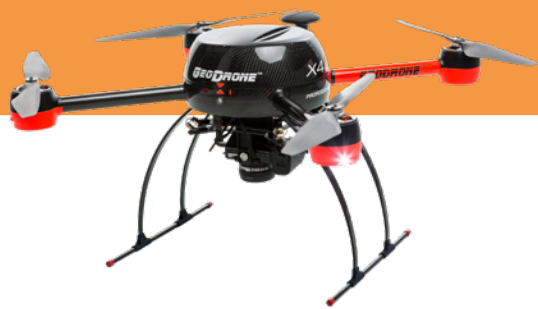
Drönare med kamera och LiDAR-skanner
